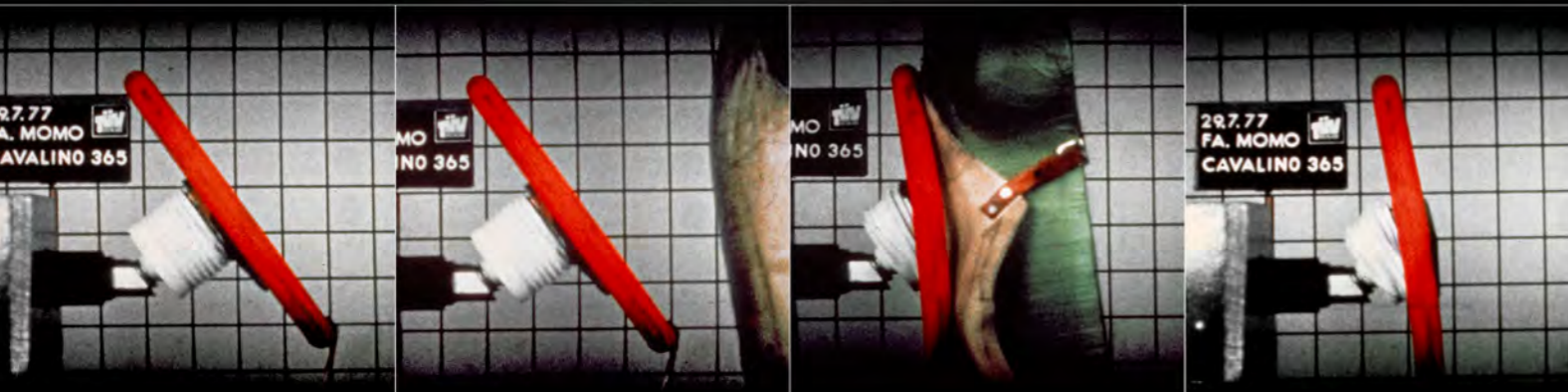
Impact test of the "dummy" against the assembly: wheel-hub-car, shows a perfect interaction of energy absorption forces. Prove d'urto del manichino contro il sistema "volante-mozzo-vettura", dimostrano un'efficiente interazione degli assorbimenti di energia.
